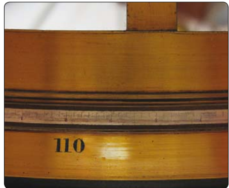
Selve skalaen på skalakredsen er indgraveret i et indlagt sølvbånd. Takket være de fire aflæsningsmikroskoper kunne deklinationen bestemmes med en fejl på kun ca. et halvt buesekund. (Foto: Hans Buhl)
